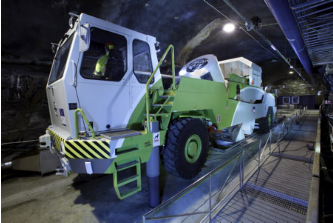
Figur 4. Bild på den vertikala deponeringsmaskinen, Magne.
