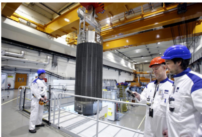
Figur 1. Hantering av transportbehållare i mottagningshallen vid CLAB.
